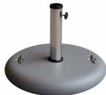
TH-40 Base de cemento. Tubo de acero inoxidable con adaptador de palos de hasta 50mm. Peso: 40Kg COD. 167537
